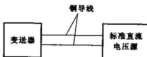
图 A.4 不具有参考端温度自动补偿时的测量接线示意图
